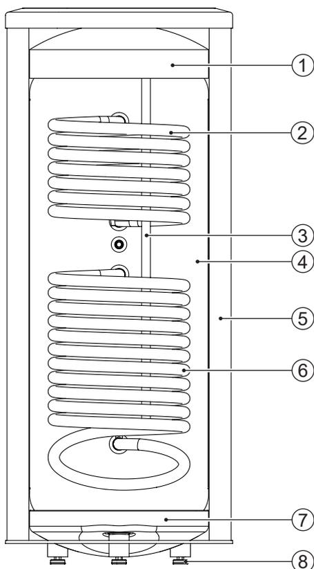
**Рис. 2** Водонагреватель W-E 220.82 N R, W-E 500.82 N R в разрезе.
