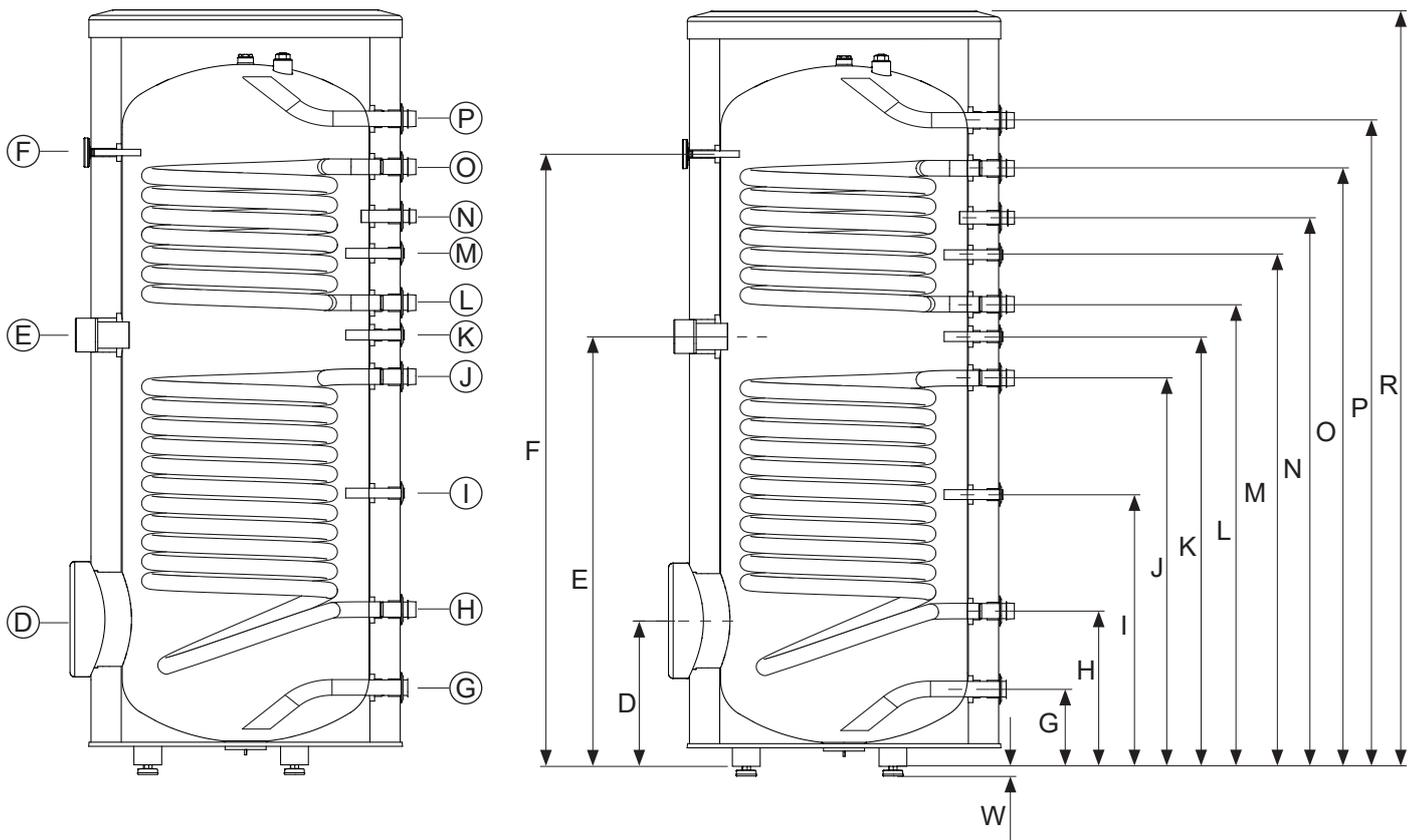
Рис. 17 Размеры водонагревателей MEGA W-E 220.82 N R и W-E 500.82 N R.
