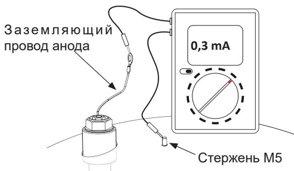
Рис. 11 Измерение силы постоянного тока защиты анода.
