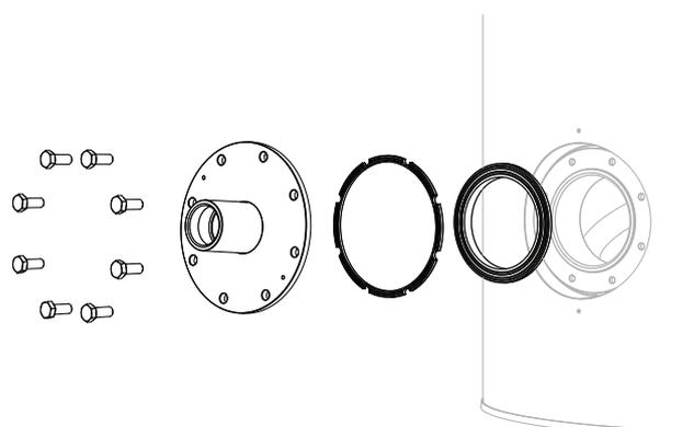
Рис. 14 Комплект для монтажа электрического нагревательного модуля - фланцевая крышка с втулкой 1 1/2".
