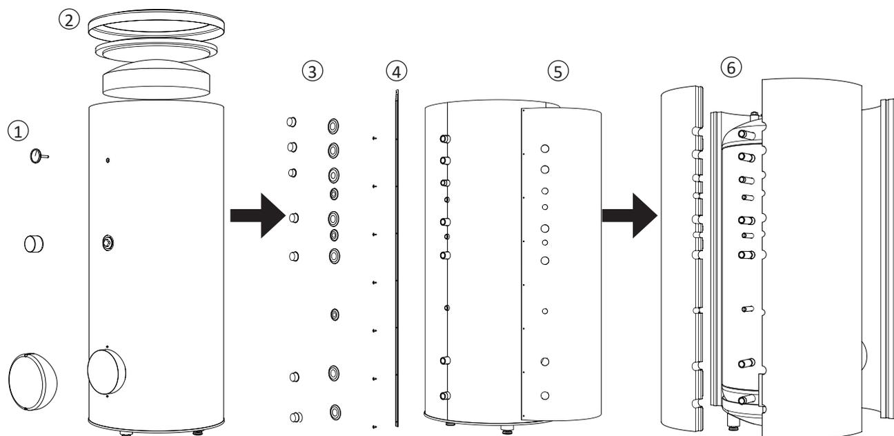
Рис. 8 Демонтаж корпуса и теплоизоляции.
