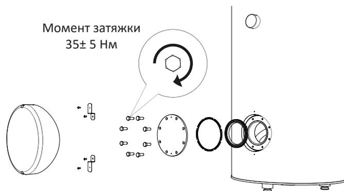
Рис. 13 Установка крышка смотрового отверстия (очередность монтажа).
