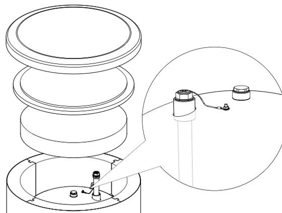
Рис. 10 Изолированный защитный магниевый анод.
