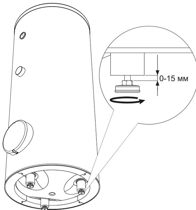
**Рис. 7** Выравнивание устройства.
