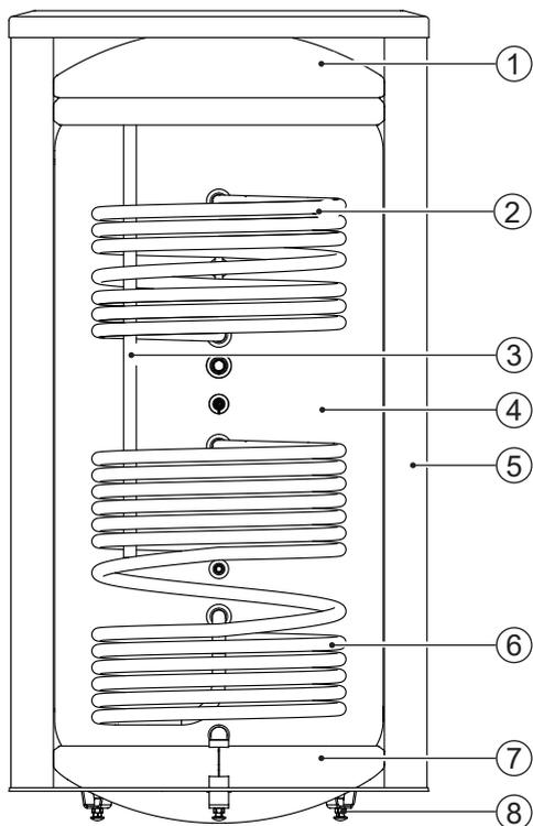
**Рис. 4** Водонагреватель W-E 750-1000.82 N R в разрезе.
