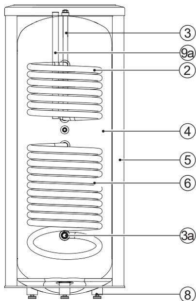
**Рис. 4** Водонагреватель W-E 300-400.82 R в разрезе.
