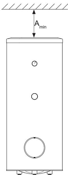
**Рис. 6** Минимальное расстояние до защитного магниевого анода.
